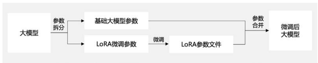
图17：LoRA微调原理图
