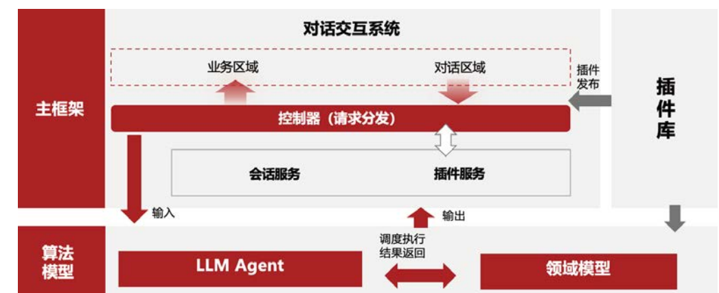
图29：基于智能体的数字员工服务调控框架
